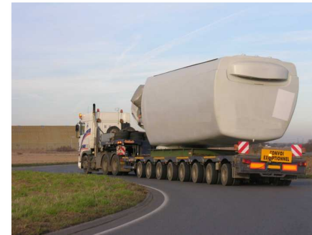
Photo 10 : Transport de nacelle (Photo : VALOREM)
